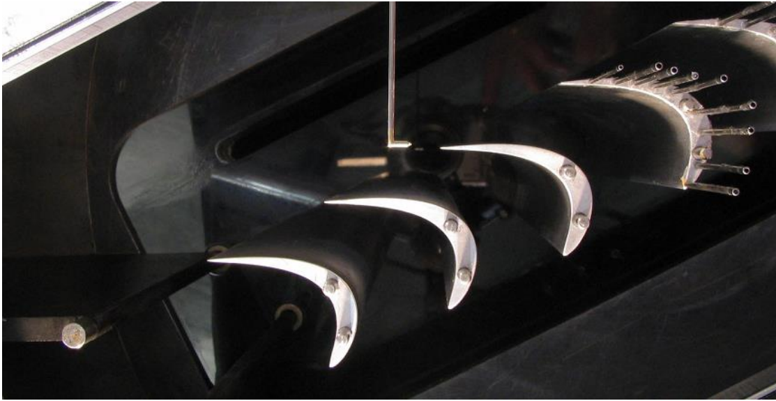
AeroProbe 的设计帮助用户获得旋转机械，如压缩机及汽轮机内的三维速度
